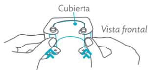
5. Por último coloca los Cilindros. Inserta los Pernos por debajo y los Tornillos por arriba, como en la **Figura 6**. Ayúdate con un desarmador para completar la instalación.
