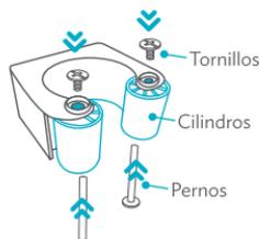
**Importante:** Desliza la llanta de la bicicleta por los Cilindros hasta el tope, asegurando que la bicicleta quede sujeta correctamente antes de soltarla.
